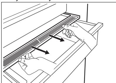
2. Pokud potřebujete vyměnit bílou membránu zařízení, uchopte zařízení uprostřed a zatažením za kryt oddělte membránu od krytu.
