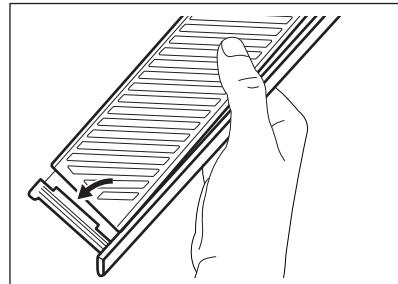
4. Zařízení pro regulaci vlhkosti připevněte zpět na zásuvku.
