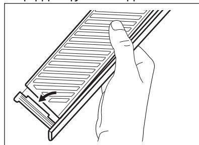
4. Επανασυναρμολογήστε το χειριστήριο υγρασίας στο συρτάρι.
