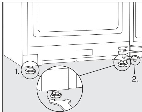
■ Vycentrujte chladničku pomocou vodováhy a priloženého vidlicového kľúča a podoprite dvierka prístroja.
