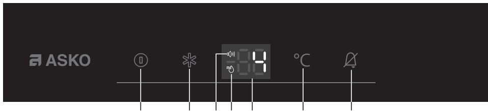
A Tlačidlo zapnutia/vypnutia spotrebiča
