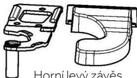
Horní levý závěs pro změnu směru otvírání dvířek
