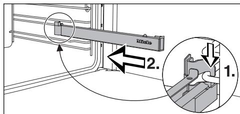
■ Zaháknite plnovýsuvné pojazdy FlexiClip vpred na spodnej strane priečky úrovne (1.) a zasuňte ho do ohrevného priestoru (2.).
