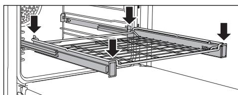
Zaťažiteľnosť FlexiClip-plnovýsuvných pojazdov je maximálne 15 kg.
