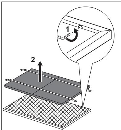
3. Führen Sie zum Einbau des neuen Filters die gleichen Schritte in umgekehrter Reihenfolge durch.
