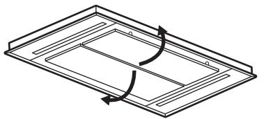
2. Druk op de handgreep van de montageclip op het filterpaneel onder de kap (1).
