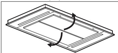
2. Premir o manípulo dos grampos de fixação no painel do filtro, por baixo do exaustor (1).
