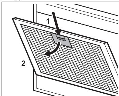
3. Incline ligeramente la parte delantera del filtro hacia abajo (2) y tire de él.
