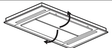
2. Натисніть ручку затискача кріплення на панелі фільтра під витяжкою (1).
