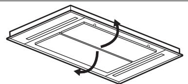
2. Πιέστε τη λαβή του κλιπ στερέωσης στο πλαίσιο του φίλτρου κάτω από τον απορροφητήρα (1).
