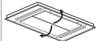
2. Stiskněte držadlo úchytky na panelu filtru pod odsavačem par (1).
