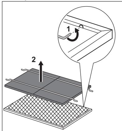
3. Uue filtri paigaldamiseks tehke samad toimingud vastupidises järjekorras.
