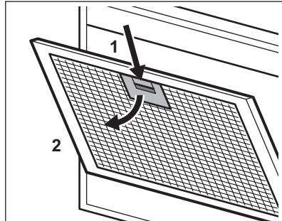
3. Kallutage filtri esiosa kergelt allapoole (2), seejärel tömmake.
