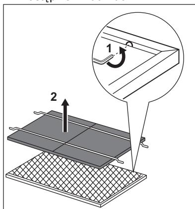
3. W celu zamontowania nowego filtra należy wykonać opisane czynności w odwrotnej kolejności.
