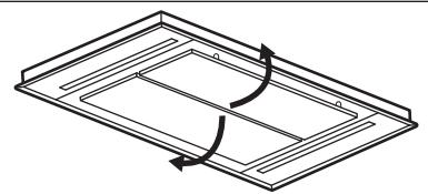
2. Stlačte rukoväť montážnej príchytky na paneli s filtrom na dolnej strane odsávača pár (1).
