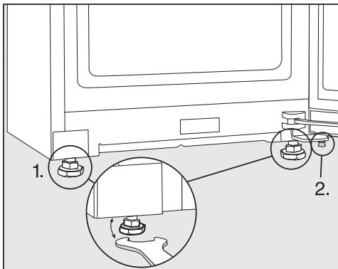
■ Vycentrujte chladničku pomocou vodováhy a priloženého vidlicového klúča a podoprite dvierka prístroja.
